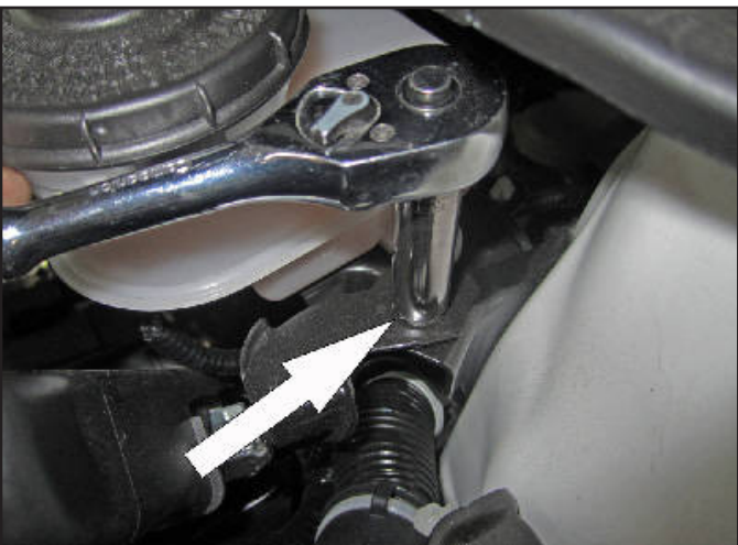
m. Remove the upper 10mm ECU bolt.
