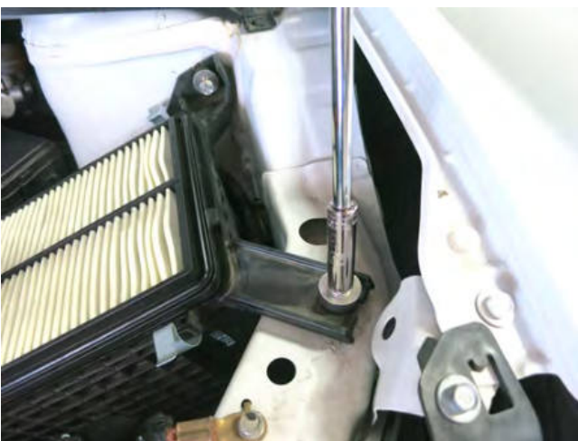
i. Remove the upper air box bolt.
