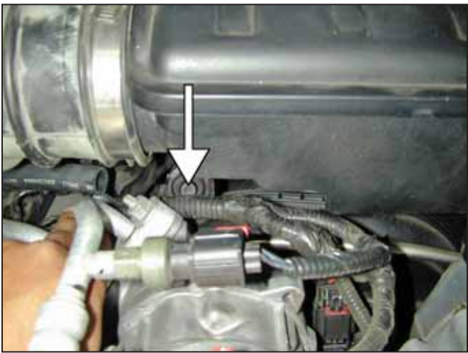
c. Loosen bottom left bolt.
